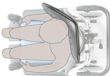
L'elevata escursione in profondità e l'ampia traslazione laterale del poggiatesta assecondano le diverse esigenze dell'utente permettendo di seguire il capo in posizione decentrata rispetto all'allineamento tronco-bacino. L'insieme delle regolazioni migliora l'orientamento visivo del soggetto
